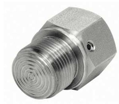
Realizados para aislar el elemento sensible de los manómetros DN63 transmisores electrónicos de presión, de fluidos de proceso corrosivos, viscosos, sedimentosos, cristalizables y con altas temperaturas. Una membrana soldada y puesta a prueba antifugas, garantiza la separación del fluido de transmisión del proceso. La construcción nos aconseja su uso donde se pide facilidad de desmontaje para garantizar la higiene con frecuentes limpiezas.
